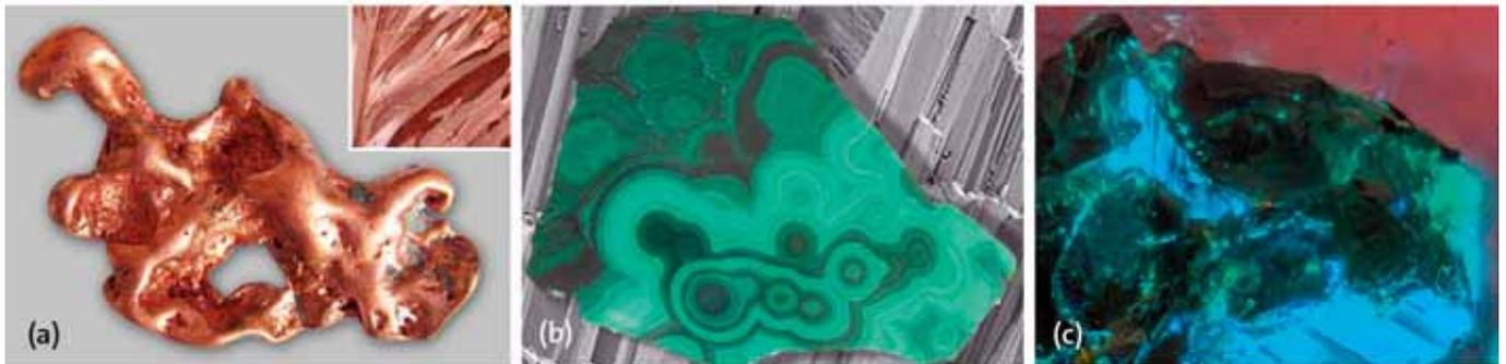
Abb. 7: Lichtwirkungen des Kupfers. (a) Metallischer Glanz und Farbe des gediegenen Kupfers, im Hintergrund: Vergrößerung von Kupferkristallen; (b) Vordergrund: Malachit mit einem Kupferanteil von ca. 55 %, Hintergrund: Rasterelektronenmikroskopische Darstellung des Malachits, die nadelförmige Kristalle sichtbar macht; (c) Zinkblende mit geringstem Kupferanteil, Verdünnungen bis zu 1 Million (1 ppm), nur die Grün-Fluoreszenz wird durch Kupfer erzeugt.
